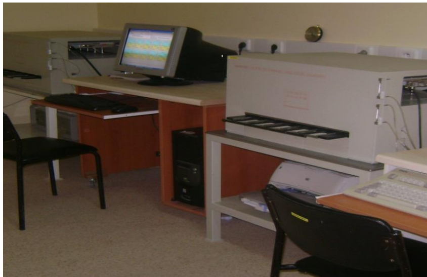
Şekil 3.1. Berthold marka LB770 model alfa-beta sayım cihazı.
