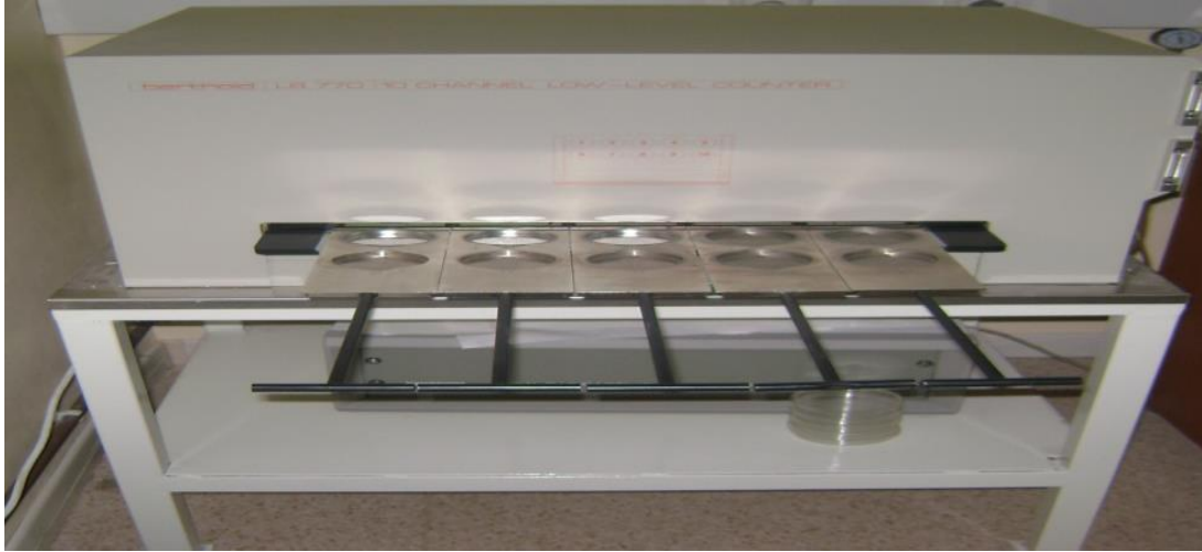
Şekil 3.2. 10 kanallı düşük seviyeli planşet kaplar.
