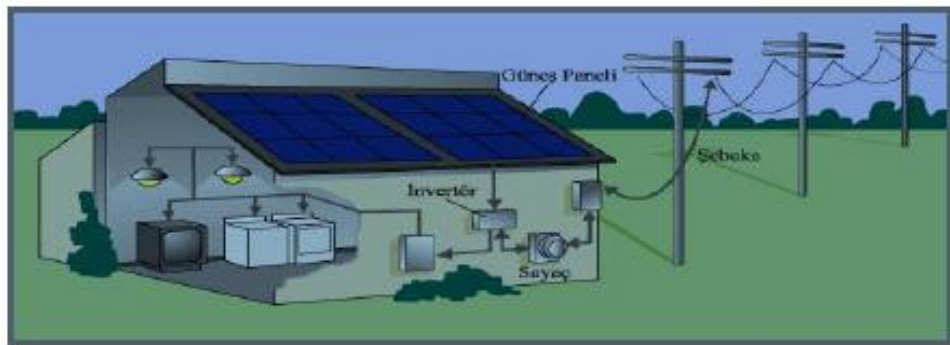
Şekil 2.14. Şebekeye bağlı evsel fotovoltaik güç sistemi örneği
