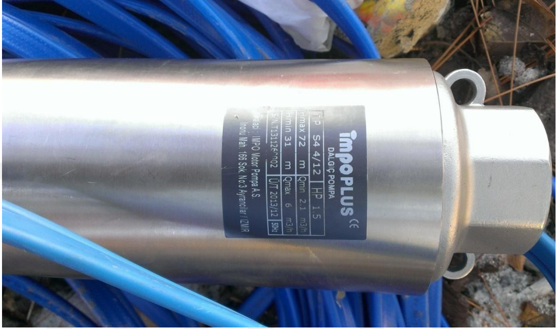
Şekil 3.9. Sondaj kuyusunda kullanılan dalgıç pompa
