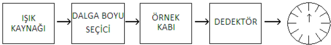
Şekil 2.4. Bir spektrofotometrenin temel bileşenleri
