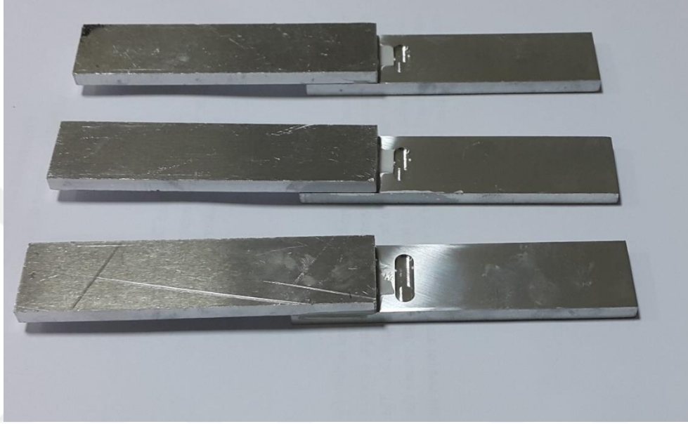
řekil 3.13. Kalıptan ıkarılan baęlantı numuneleri
