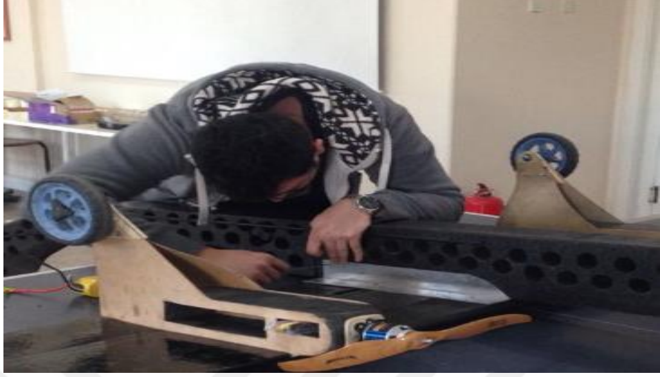
Şekil 3.38. Orta kanat-gövde birleşimi
