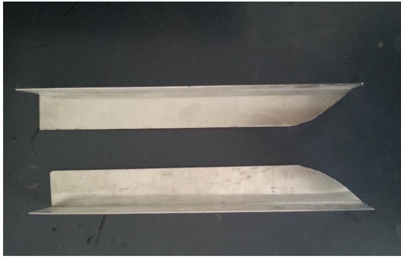
Şekil 3.35. Gövde sabitlenmesi için alüminyum sacdan kesilen parça
