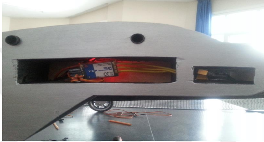
Şekil 3.40. Esc'nin motora bağlanması
