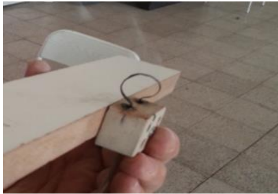
Şekil 3.21. Kanal kesim işleminde kullanılan aparat
