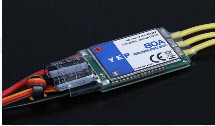
Şekil 3.15. Yep marka 80A fırçasız motor ESC ( hobbyking.com, 2017 )
