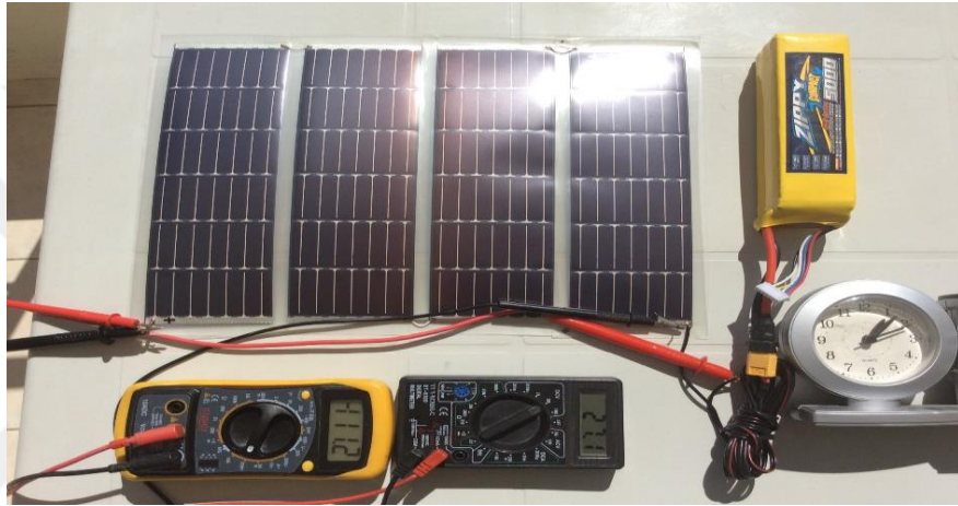
Şekil 4.1. 4 adet güneş hücresinin seri bağlanarak pile vereceği akım değerinin ölçülmesi
