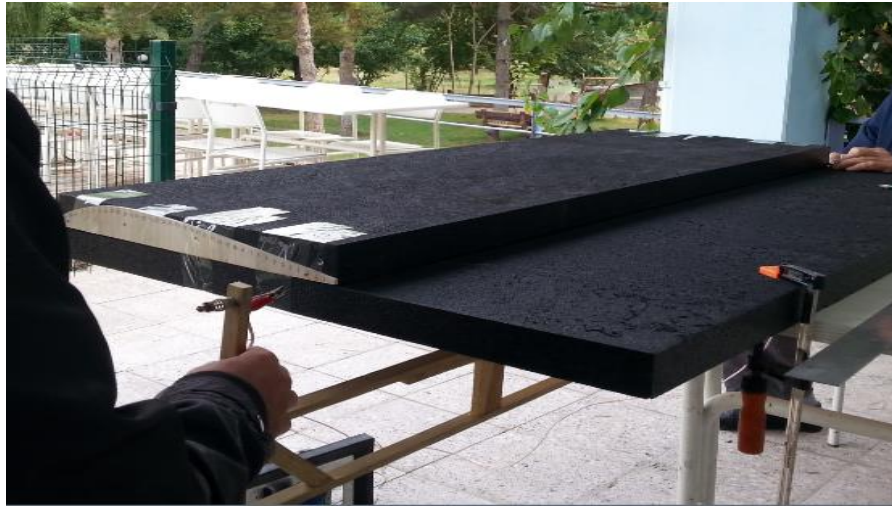
Şekil 3.19. Kızgın tel kesim tekniği
