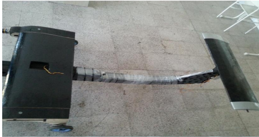
Şekil 3.39. Elevatör - rudder kablolarının alıcıya taşınması
