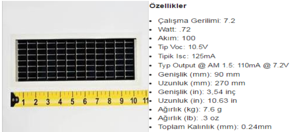
Şekil 3.14. Güneş hücresi teknik özellikleri ( www.powerfilmsolar.com, 2017 )
