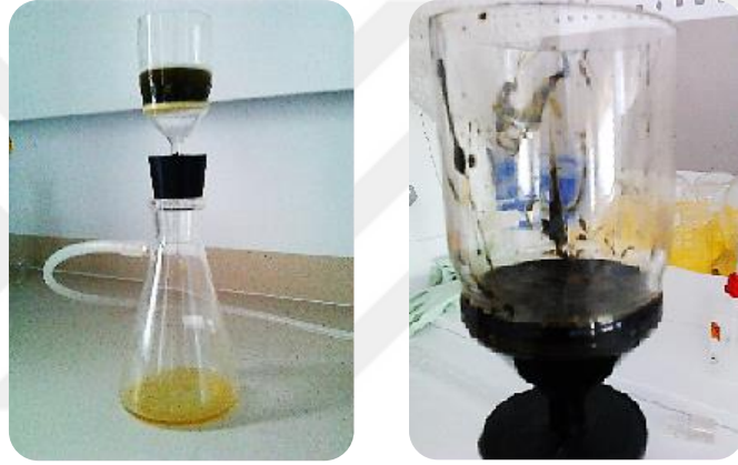
Şekil 3. 1. Vakum altında süzülmesi ve klorofillerin ayrılması
