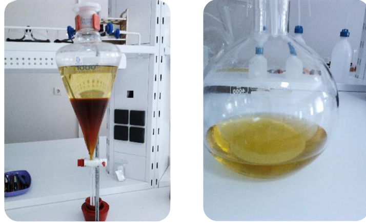
Şekil 3. 2. Bütanol ile ekstraksiyon
