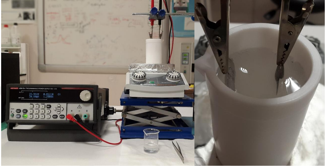
Şekil 3.3. TND oluşumunda kullanılan anodizasyon düzeneği
