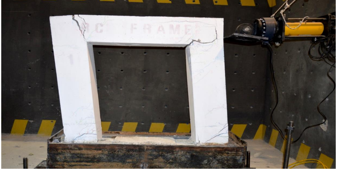
Şekil 5.3. Boş çerçeve deney sonrası
