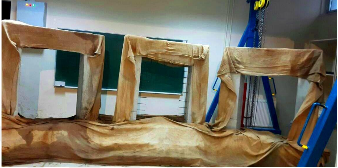
Şekil 4.16. Beton dökümü gerçekleşen numunelere kür uygulaması
