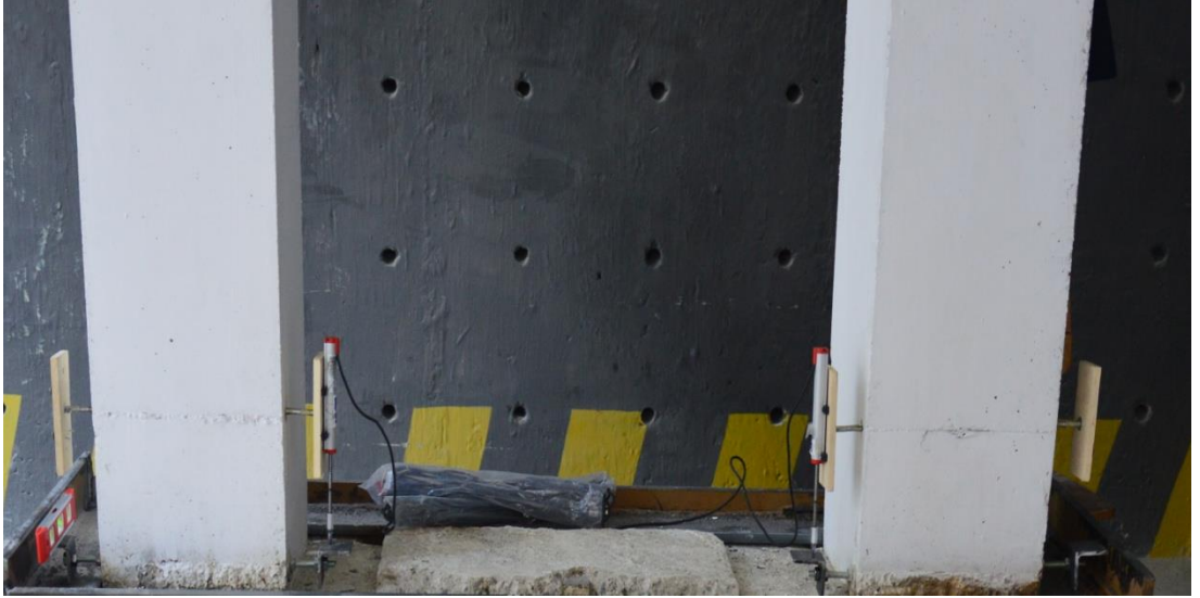
Şekil 4.21. 100 mm LVDT'lerin montajı
