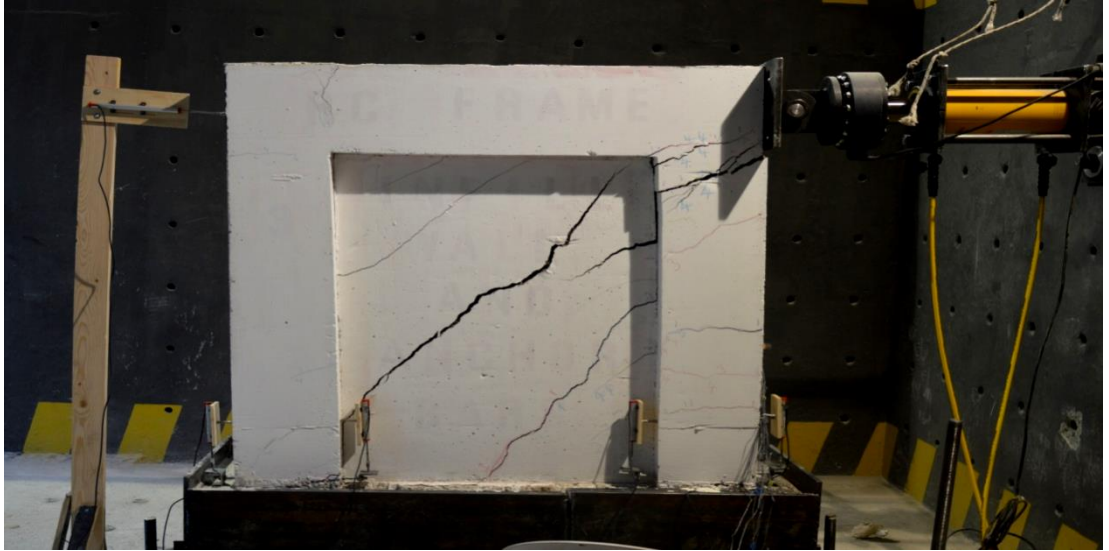
Şekil 5.9. Ankraj çubuklu dolgu duvarlı çerçeve deney sonucu
