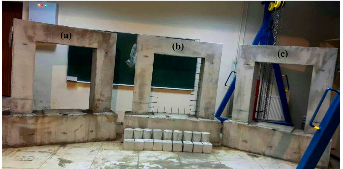
Şekil 4.15. Kalıptan çıkarılan numunelere ait resim ((a) Dolgu duvarlı çerçeve, (b) Ankraj çubuklu dolgu duvarlı çerçeve ve (c) Boş çerçeve)
