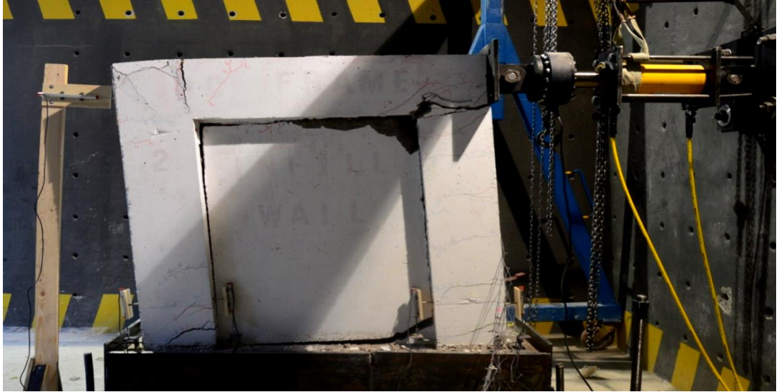
Şekil 5.6. Dolgu duvarlı çerçeve deney sonucu
