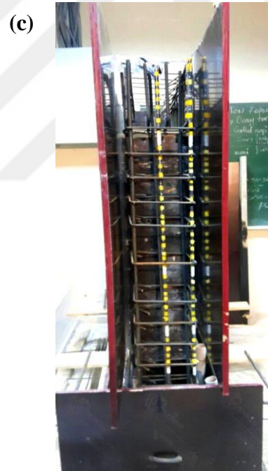
Şekil 4.10. Gerinim pullarının donatı çeliğine yapıştırılma aşamaları ((a) Donatı pürüzsüzleştirme, (b) Gerinim pulu ve (c) Bir kolonda yer alan gerinim pulu)
