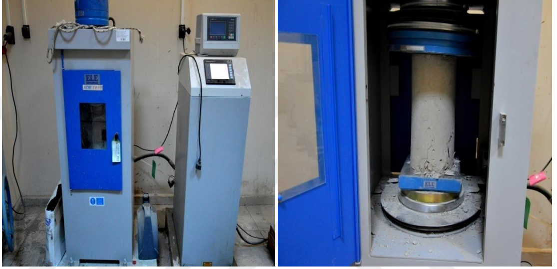
Şekil 4.20. Küp ve silindir numunelerin basınç deneylerinin yapılması
