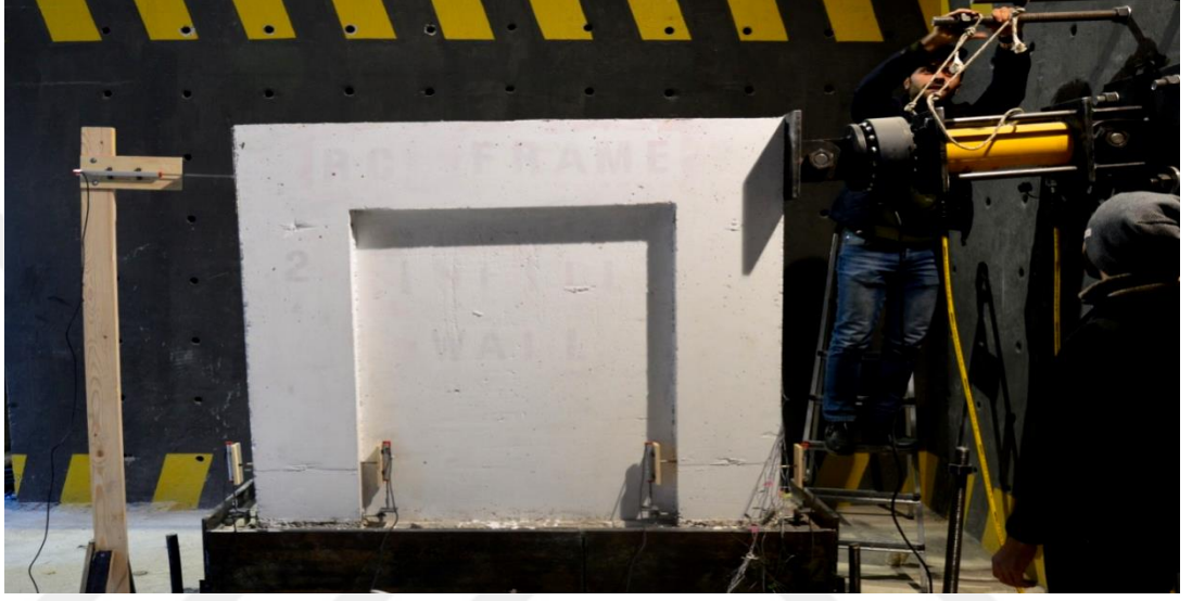
Şekil 5.5. Dolgu duvarlı çerçeve deney başlangıcı
