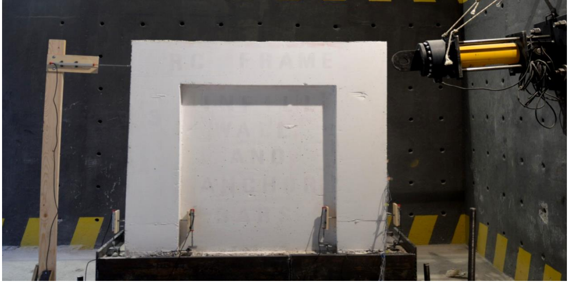
Şekil 5.8. Ankraj çubuklu dolgu duvarlı çerçeve deney başlangıcı
