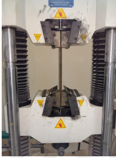
Şekil 3.3. Çelik donatı mekanik özelliklerinin belirlenmesi
