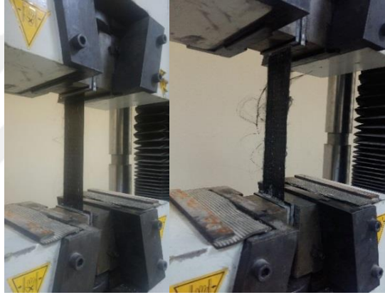
Şekil 3.7. ASTM D3039/D3039M-08'e göre gerçekleştirilen CFRP çekme deneyi ve kopma anı
