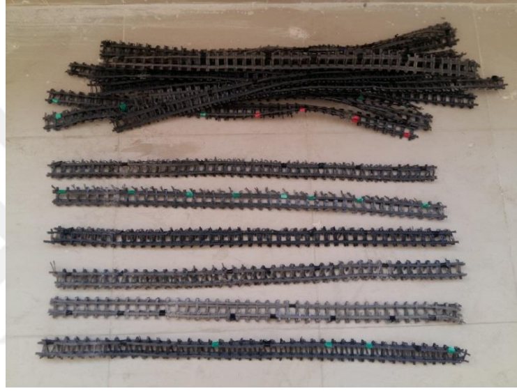
Şekil 3.22. Geogrid malzemenin geleneksel kapalı etriye olarak kullanımını için hazırlanması
