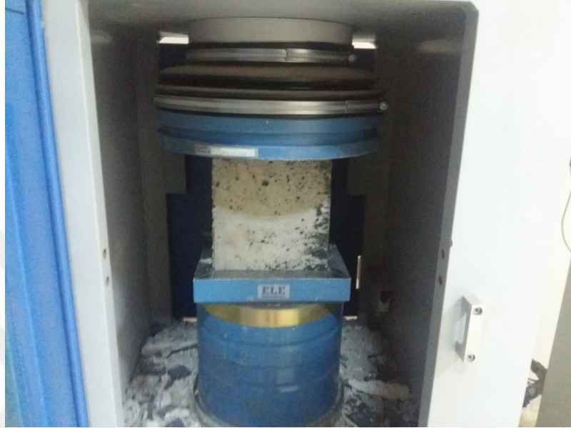
Şekil 3.2. Beton dayanım tespiti
