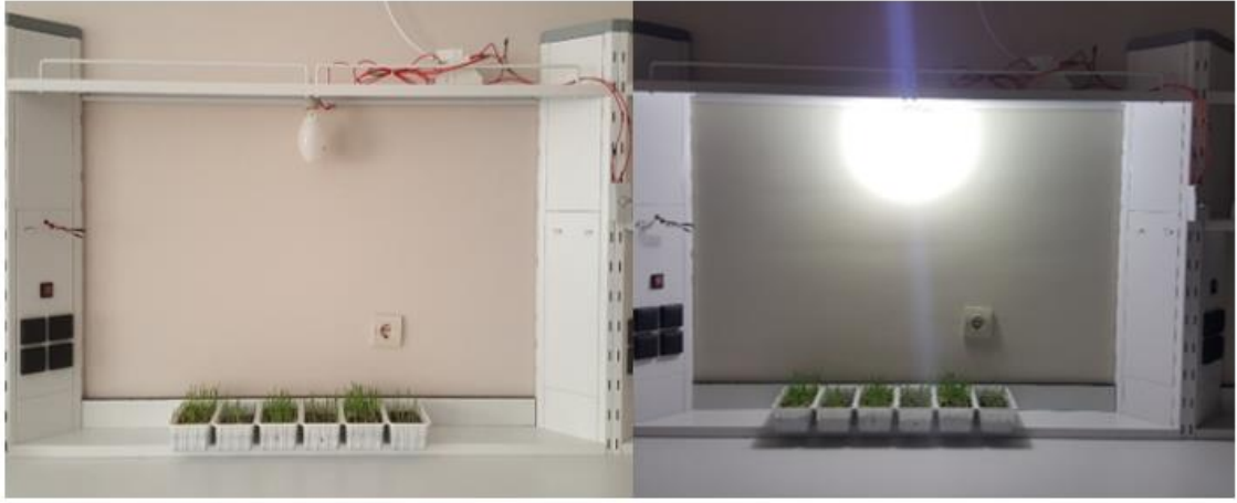
Şekil 4.11. Cıva buharlı lambanın monte edildiği aydınlatma sistemi.
