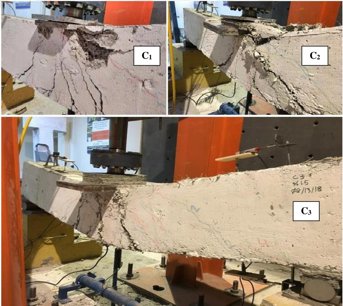
Şekil 4.3. C grubu betonarme kirişlerinin yük kaldırılmadan önce çatlak dağılımları; (C 1 ) = %0; (C 2 ) = %0,5; (C 3 ) = %1,5 plastik fiber katkılıdır.
