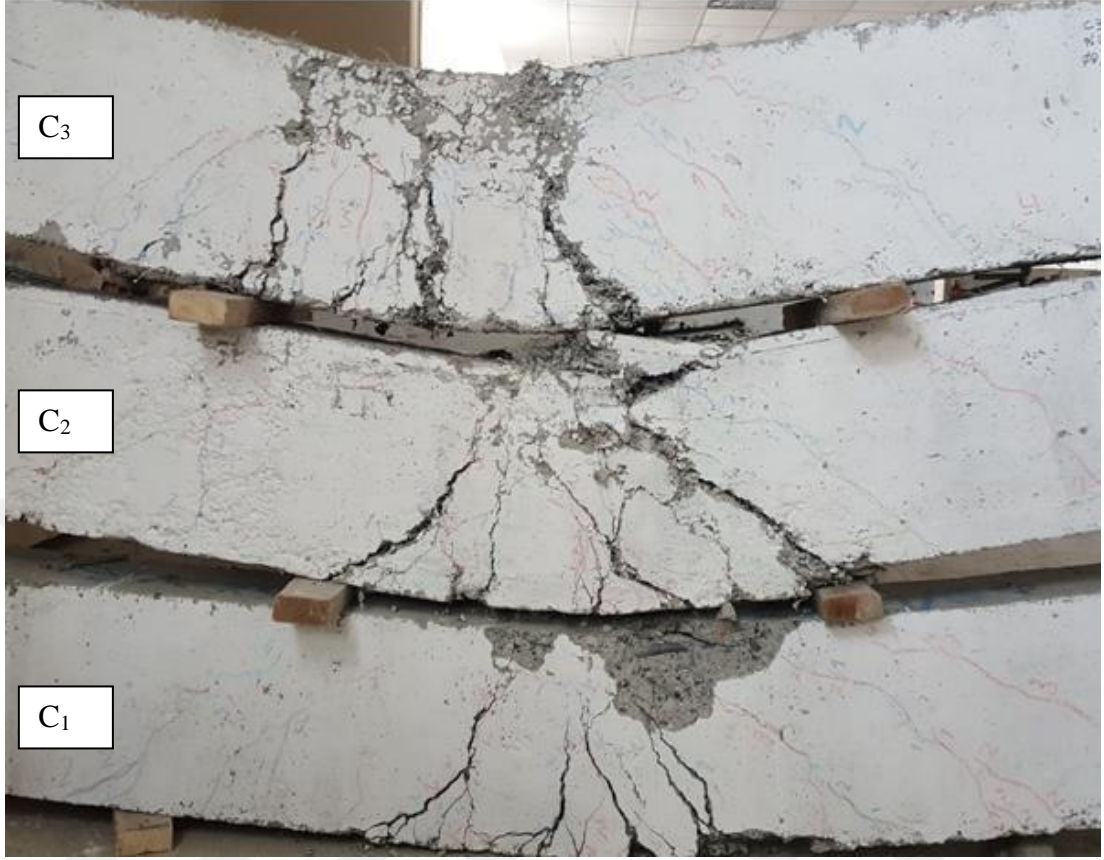
Şekil 4.4. C grubu betonarme kirişleri için çatlak desenleri; (C 1 ) = %0; (C 2 ) = %0,5; (C 3 ) = %1,5 plastik fiber katkıdır.
