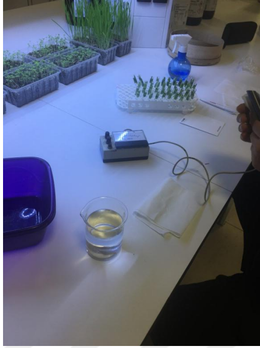
Şekil 4.9 Elektrolit sızıntı ölçümü
