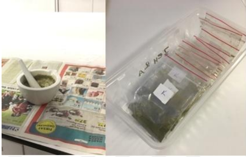
Şekil 4.11 Element alımı tayini için toz haline getirme işlemi
