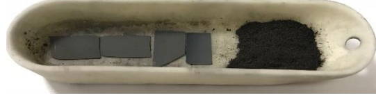
Şekil 4.3. Alümina bot içerisindeki kaynak malzemeler ve altlık malzemeleri
