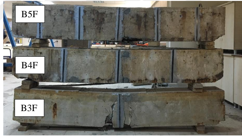
Şekil 4.30. Korozyona maruz kalmış ve CFRP ile güçlendirilmiş kirişler
