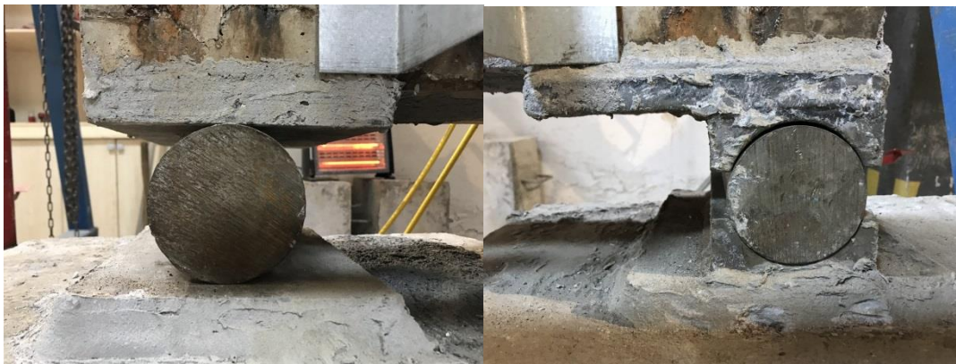
Şekil 4.34. Kirişlerde kullanılan hareketli ve sabit mesnet
