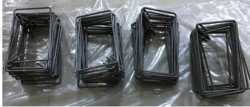
Şekil 4.6. Betonarme kirişlerin etriyelerinin ayrılması
