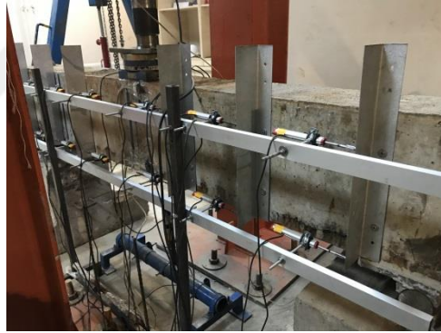
Şekil 4.36. 12 adet eğrilik ölçmek için yerleştirilen LVDT
