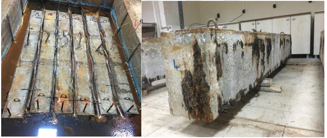
Şekil 4.20. Betonarme kirişlerin hızlandırılmış korozyona tabi tutulması
