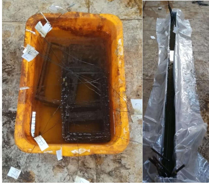
Şekil 4.28. Betonarme donatıları hidroklorik asit ile kimyasal temizleme
