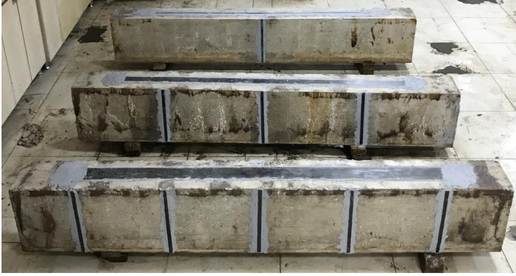
Şekil 4.23. FRP malzemesi uygulanmış betonarme kirişler
