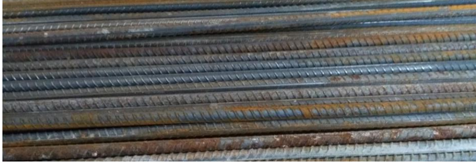
Şekil 4.3. Mekanik temizleme için hazırlanan betonarme demir numuneleri
