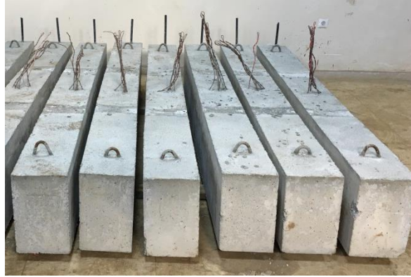
Şekil 4.15. Deney için hazırlanan betonarme numuneler
