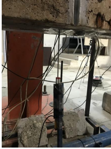
Şekil 4.35. Yük – Yerdeğiştirme için kiriş ortasına yerleştirilen LVDT
