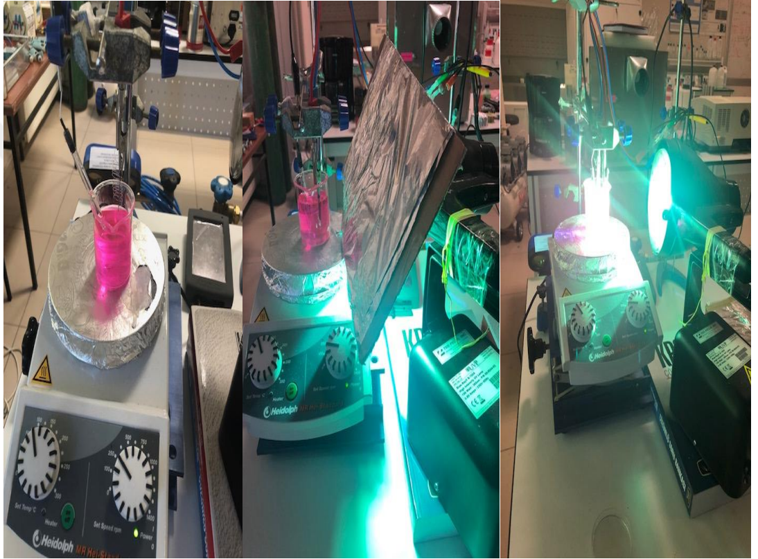
Şekil 3.6. Foto-elektrokataliz deney düzeneği
