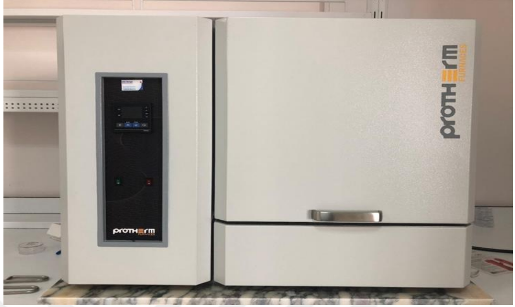
Şekil 3. 3. TND'lerin tavllanması için kül fırını
