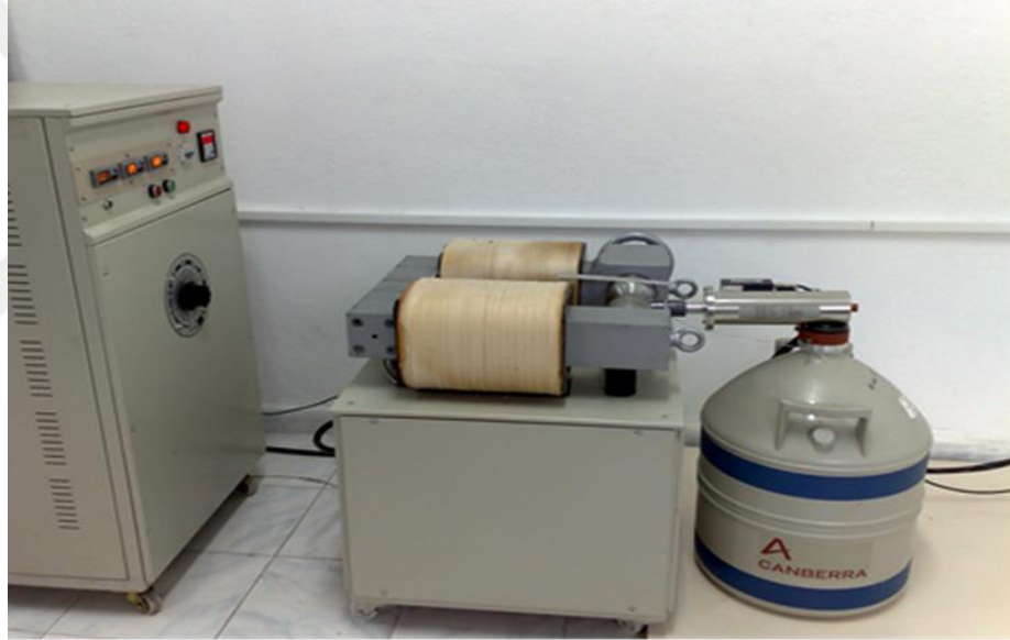
Şekil 3.4. EDXRF Sistemi, Elektromagnetler ve Güç Kaynağının Gösterildiği Deneysel Geometrisine Ait Fotoğraf.
