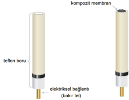
(b) Bir ucunda elektriksel iletim için bakır bulunan içi boş teflon boru
