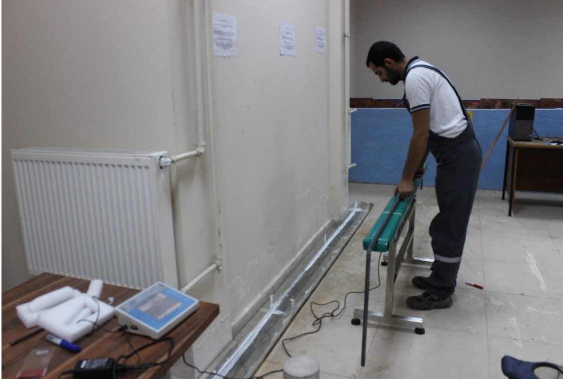
Şekil 4.5. Kiriş Donatılarının Tartılması
