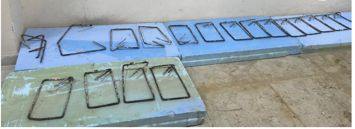
Şekil 5.2. Paslandırılmış Kirişlerden Çıkan Sargı Donatıları
