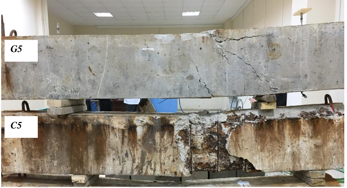
Şekil 5.21. G5 ve C5 Kırım Sonrası Çatlak Desenleri
