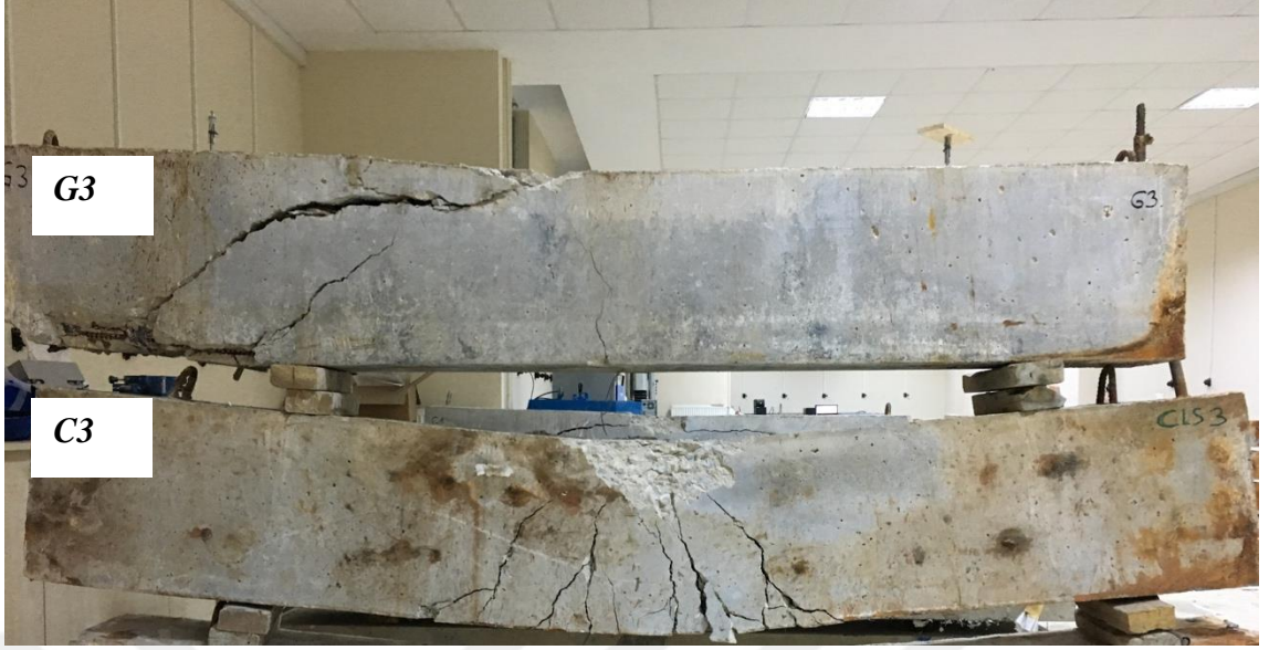
Şekil 5.17. G3 ve C3 Kırım Sonrası Çatlak Desenleri
