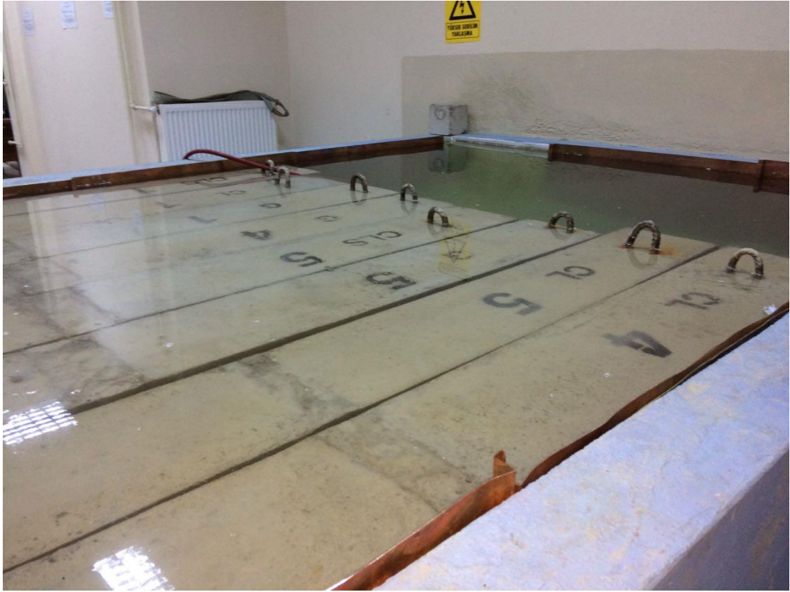
Şekil 4.12. Betonarme Kirişlerinin Kürlenmesi
