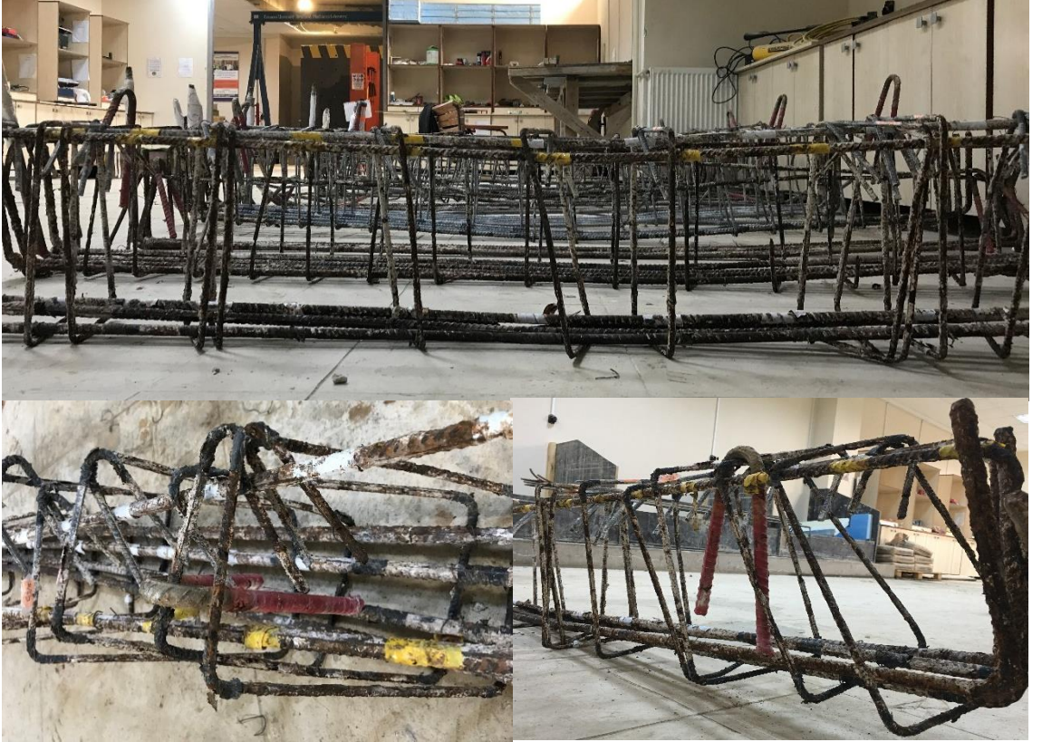
Şekil 5.1. Paslandırılmış Kirişlerinden Çıkarılan Donatılar
