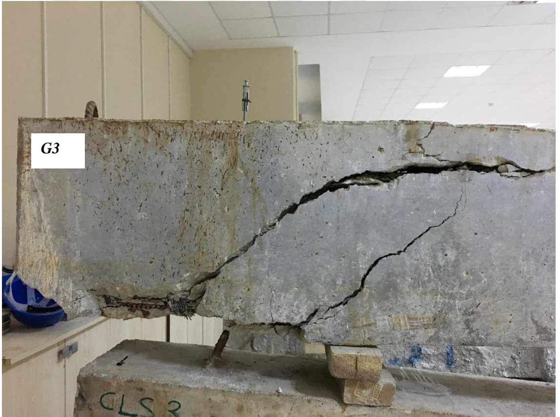
Şekil 5.18. G3 Detaylı Çatlak Desenleri
