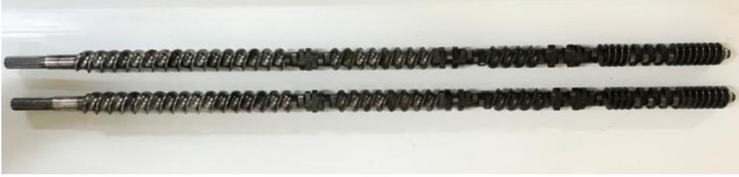
Şekil 2.5. Çift vidalı gıda ekstrüderine ait vidaların görüntüsü
