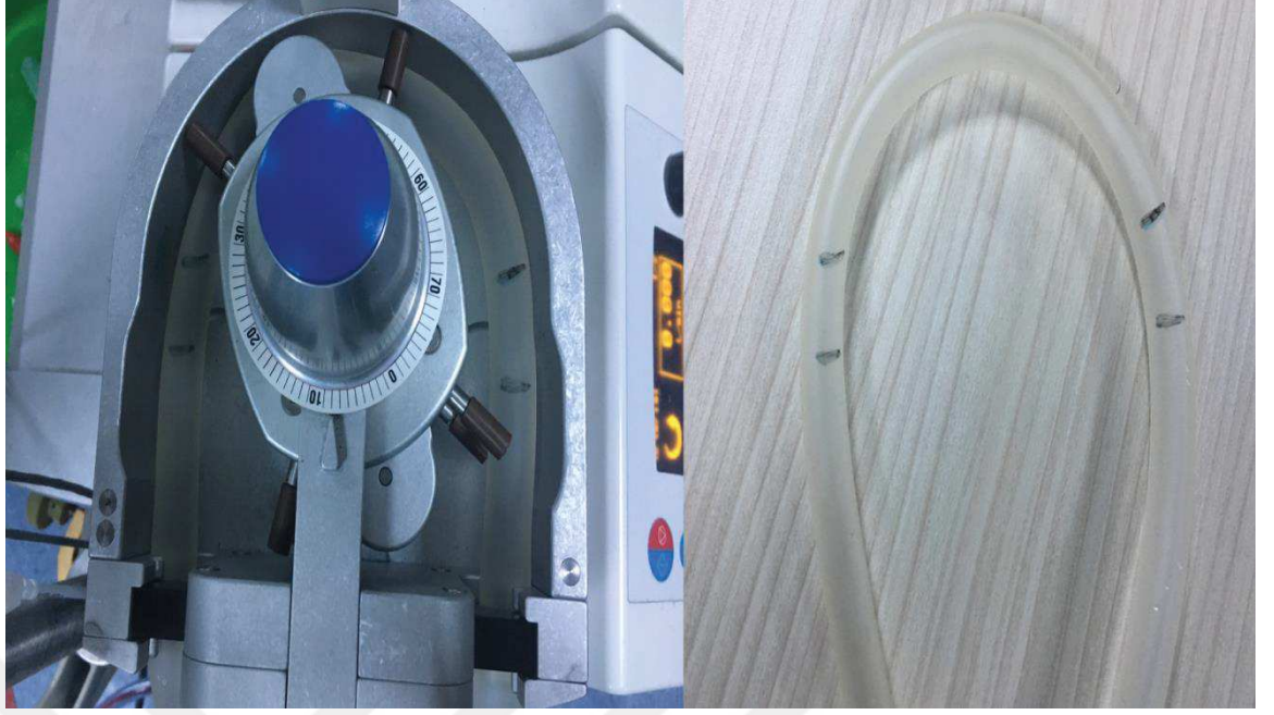
Resim 2: Roller arklarının tp yzeyine en fazla hasar verdiĐi blgeler
