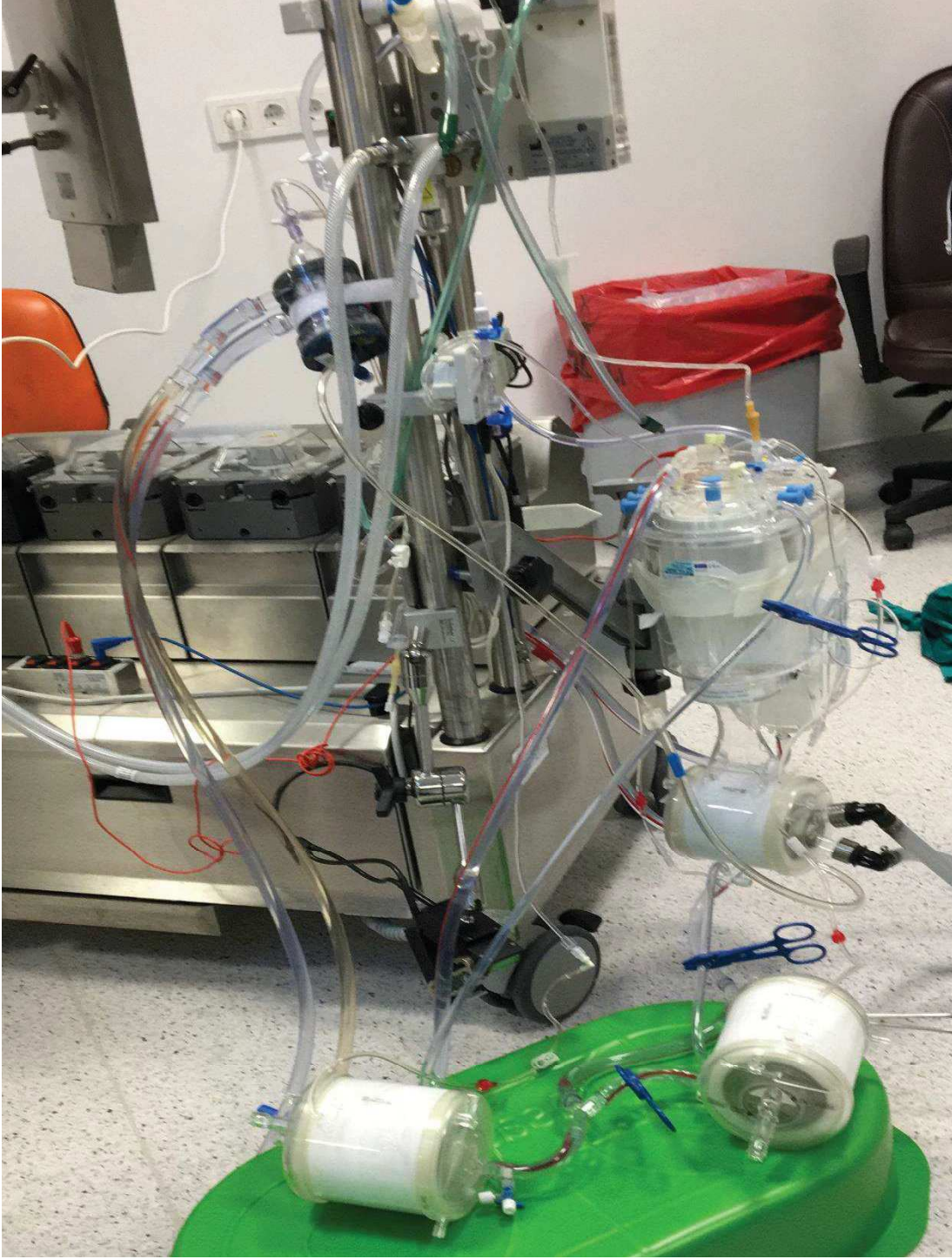
RESİM 7: DENEY SİMÜLASYON MODELİ İÇİN OLUŞTURULAN KARDİYOPULMONER BAYPAS DEVRESİ
