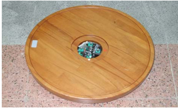
Resim 2: MD SP 300 Dinamik denge platformu görülmektedir.
