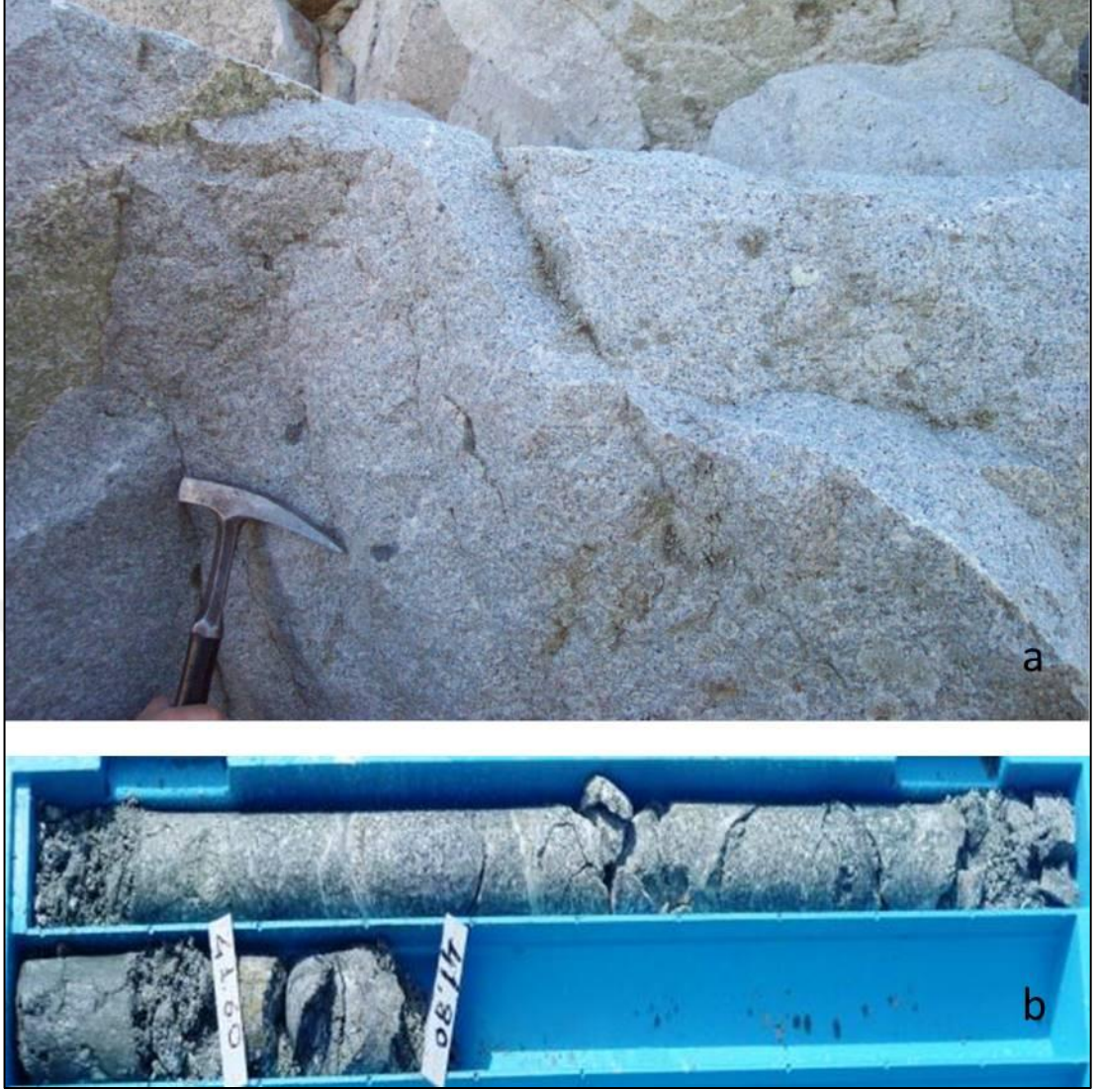
Şekil 3.4: a) Şahmuratlı civarında gözlenen Kerkenez granodiyoritinin arazi görüntüsü (Akçe, 2010) ve Kerkenez granodiyoritinden bir görünüm b) Kerkenez granodiyoritinin sondaj karotu görüntüsü.
