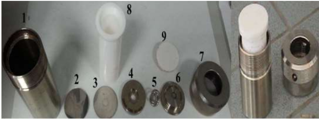
Şekil 2.1: Reaktör parçaları. (1) Paslanmaz çelikten yapılmış reaktörün dış kabı, (2) korozyon disk, (3) patlama disk, (4) düşük basınç plakası, (5) düşük ve yüksek basınç plakalarını dengeleyici yay, (6) yüksek basınç plakası, (7) reaktörün dış kapağı, (8) çözeltinin konulduğu teflon kap ve (9) teflon kabın kapağı.
