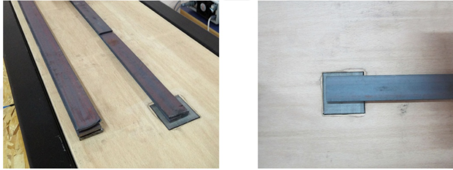
Şekil 2.1: Ferromanyetik örneklerin mıknatıslayıcı çekirdek üzerine yerleştirilmesi.
