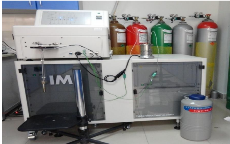
Şekil 2.11: Hidrojen depolama sistemi
