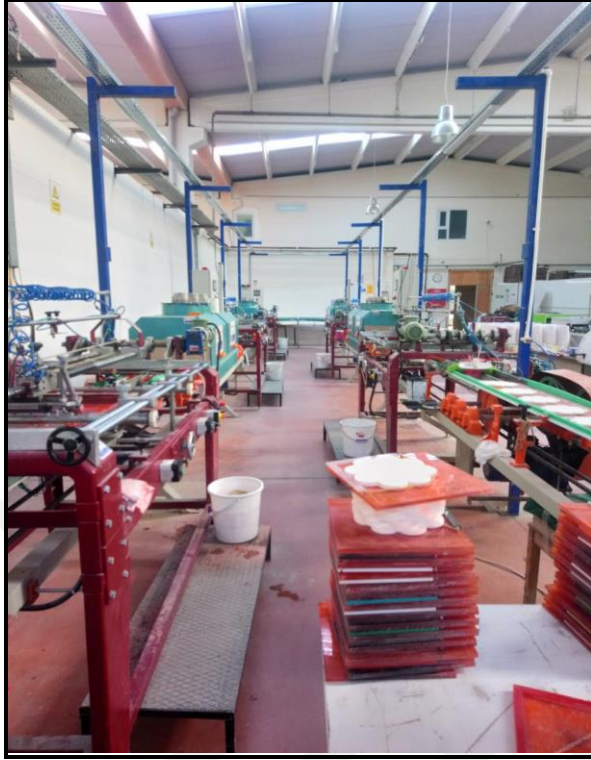
Resim 3.15: Dört Elekli Basım (Seriğrafi) Makinesi Görseli
