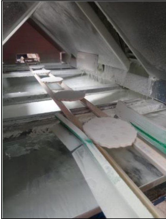
Resim 3.4: Astar ve Sırlama Makinesinin Çalışırken İçten Görüntüsü
