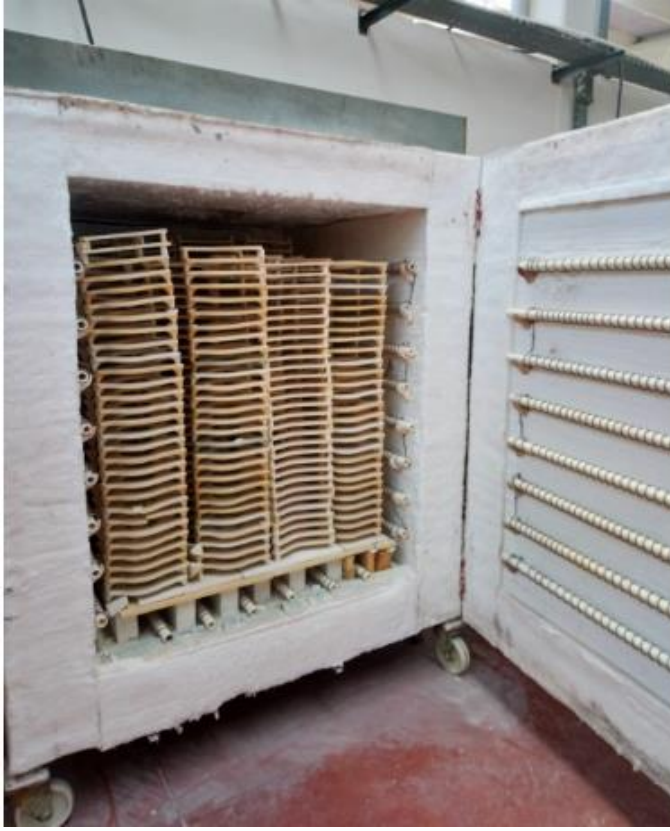
Resim 1.8: Fettah Çini Atölyesinde Roller Fırının Kurulumundan (Doğalgazlı Fırın) Sonra Kullanımı Durdurulmuş Kamara Fırını
