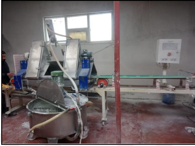
Resim 3.3: Fettah Çini Atölyesinde Kullanılan Hem Astar hem de Sırlama Makinesi (Püskürtme Yöntemi Kullanılmaktadır)
