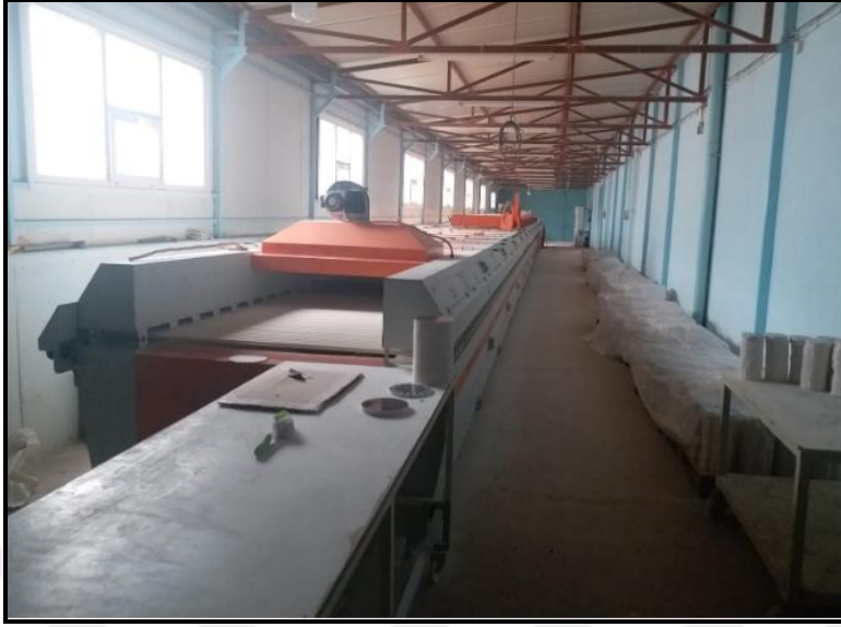
Resim 3.6: Roller Fırın Ürünlerin (Astarlı ve Sırlı) Pişmiş Olarak Alındığı Kısımını
