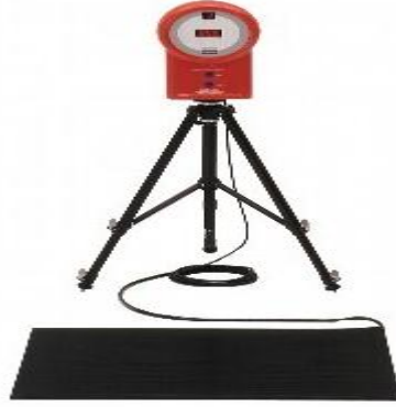
Resim 3.4. Dikey sıçrama ölçüm cihazı
