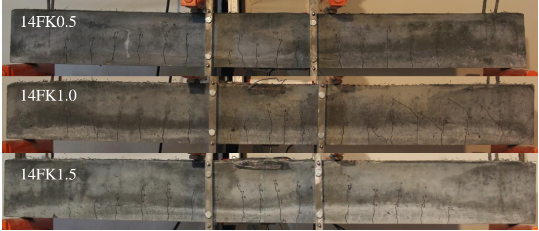
Şekil 3.37: 2φ14 donatılı poliamid lifli kirişlerin L/250 yerdeğiřtirmesi için çatlak dağılımları
