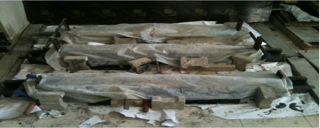
Şekil 2.9: Plastik örtü ile kürlenmiş deney kirişleri
