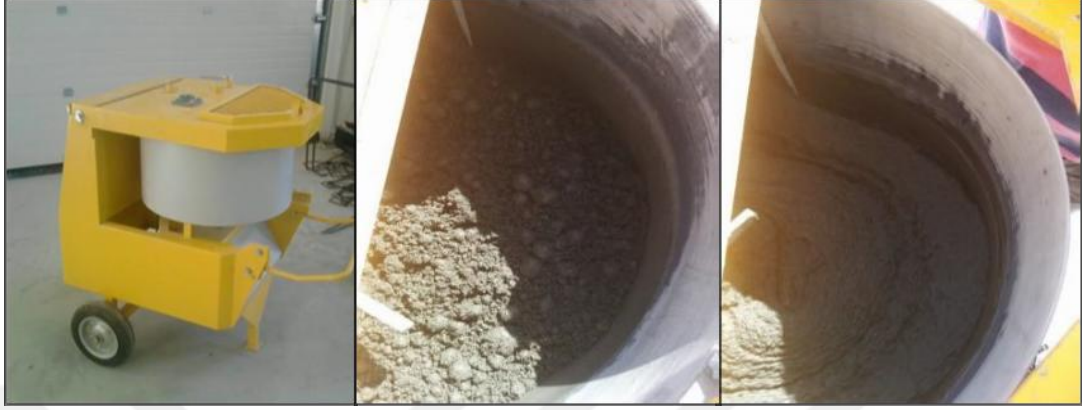
řekil 2.6: UYPLB'un panmikserde hazırlanması ařamaları
