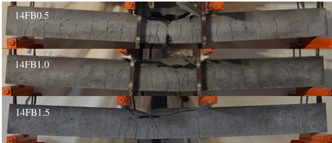
Şekil 3.13: 2\phi 14 donatılı bazalt lifli kirişlerin kırılma şekilleri
