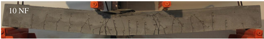
Şekil 3.3: 2φ10 donatılı liffsiz kirişin kırılma şekli
