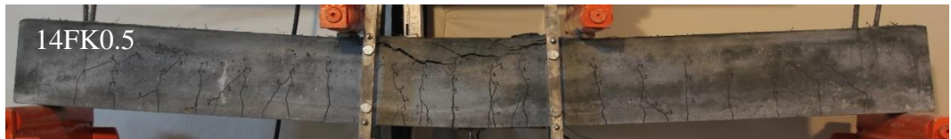
Şekil 3.29: 2φ10 donatılı poliamid lifli kirişlerin kırılma şekilleri
