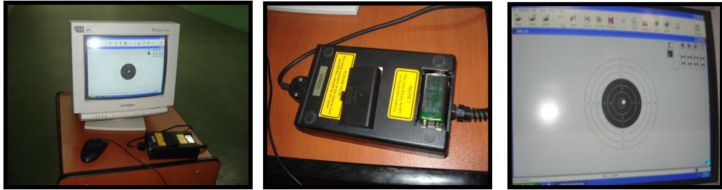
Resim 3.9. Noptel ST-2000 Lazerli sistemin tüfek ve hedef arasında ki vuruş takibini ve değerlendirmesini gerçekleştiren sistem.
