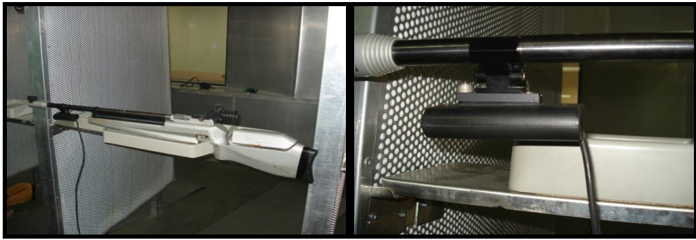
Resim 3.8. Noptel ST-2000 Lazerli sistemin Test tüfeklerine Monte şekli.
