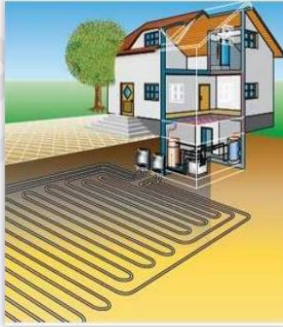
Şekil 3.6: Yatay tip topraklı ısı pompası şematik gösterimi [24]
