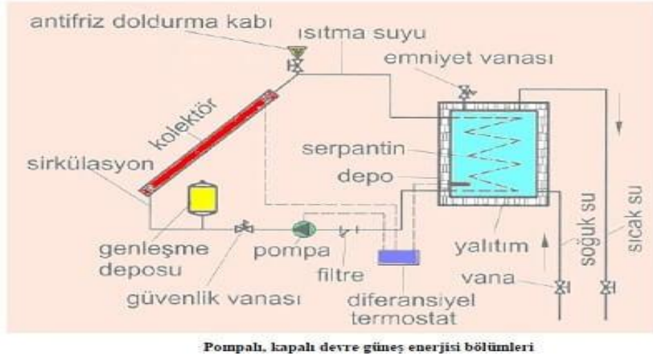
Şekil 2.4: Cebri dolaşimli kapalı devreli sistemlerin şeması [45]
