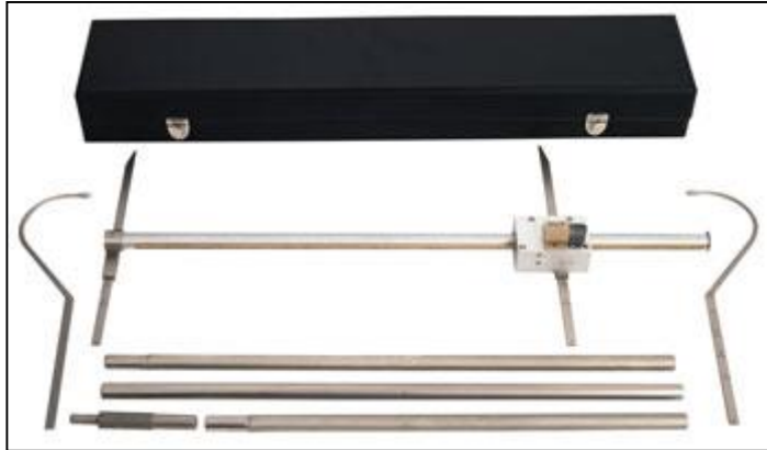
Şekil 2.4: Çap Ölçümü İçin Kullanılan Kayan Kaliper
