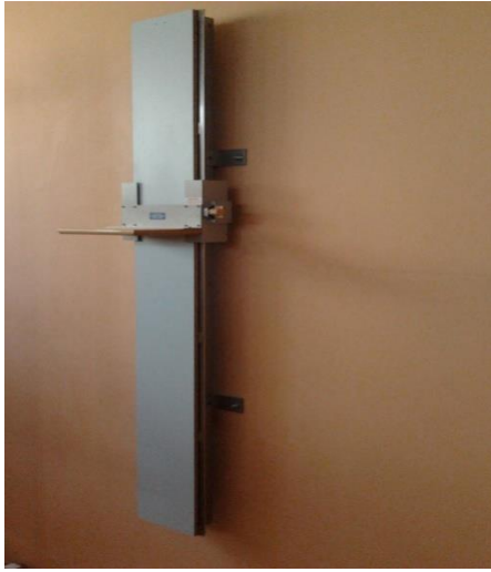
Şekil 2.1: Boy Ölçümü İçin Kullanılan Stadiometre
