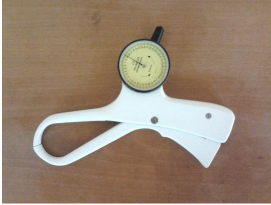
Şekil 2.3: Deri Kıvrımı Kalınlığı Ölçümü İçin Kullanılan Kaliper
