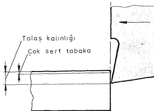
Şekil 3.14. Dökme demirin pozitif talaş açılı kalemle işlenmesi.
