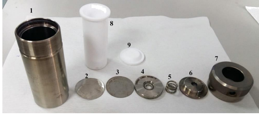
Şekil 2.2: Hidrotermal kristal büyümesi için parr asit reaktörü.
