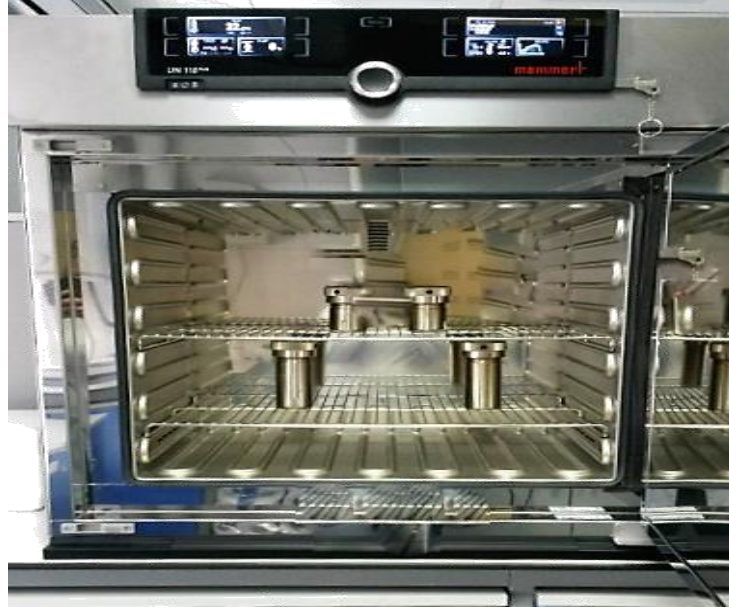
Şekil 2.3: Kristalleşmenin gerçekleştiği programlanabilen fırın.
