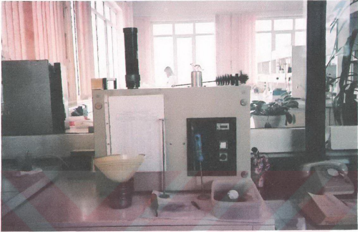
Şekil 6.2. Toni Technik marka otomatik Blaine aleti.
