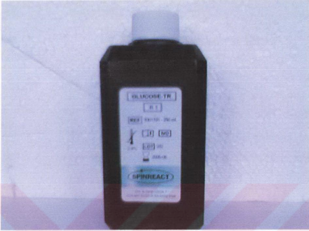
Şekil 3.9 Kan, karaciğer ve beyinde glukoz tayini yapmak için kullanılan spektrofotometrik glukoz tavin kiti
