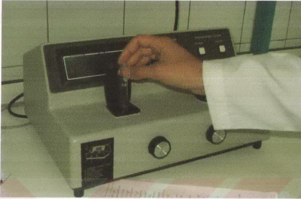
Sekil 3.25 Perkin Emler spektrofotometre ile glukoz ve lipid tayini yaparken.
