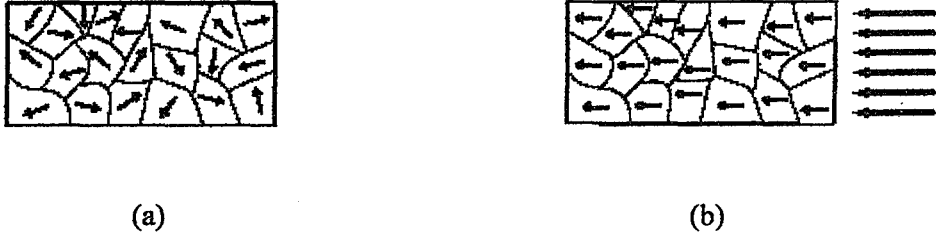
Şekil 1.13 (a) Genelde bir metalde domainler maddenin manyetize olmasını engeller. (b) Dışarıdan uygulanan manyetik alan altında domainlerin yönelişi.
