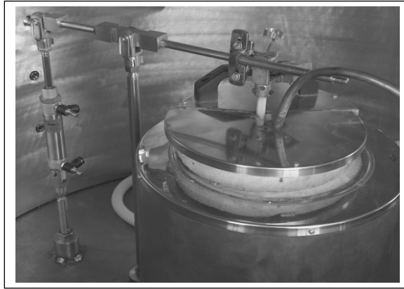
Şekil 4.3. Ergitme fırını ve pnömatik sistem.
