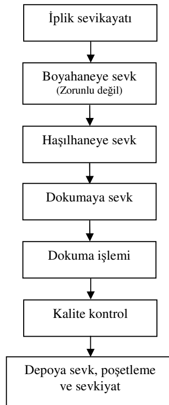
Şekil 4.1 Dokuma fabrikalarının üretim akışı
