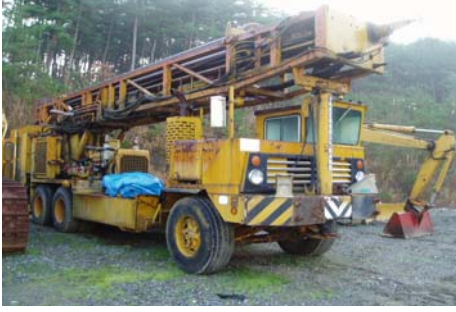
Şekil 3.3. Ingersoll-Rand T 4 BH tipi delik makinası
