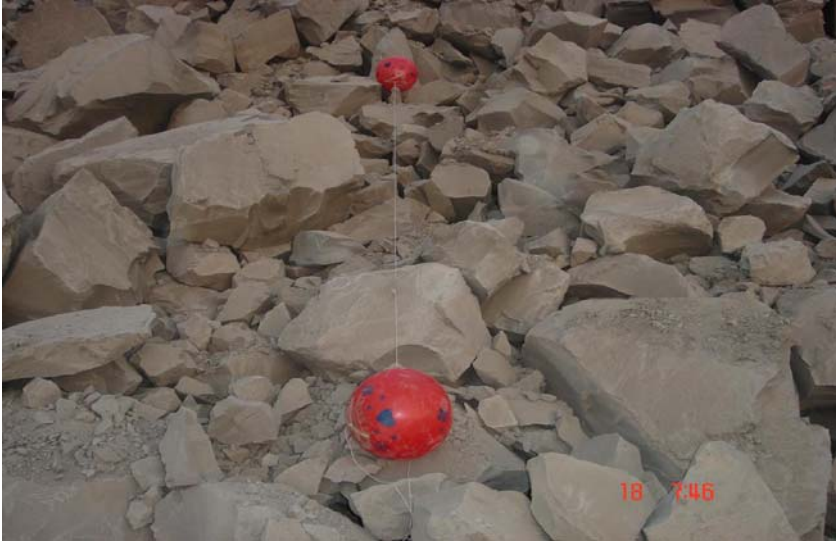
Şekil 4.17. Boyut dağılımı analizinin uygulandığı bir yığın görüntüsü, 7 m x 5 m delik düzeni (orta ölçek)
