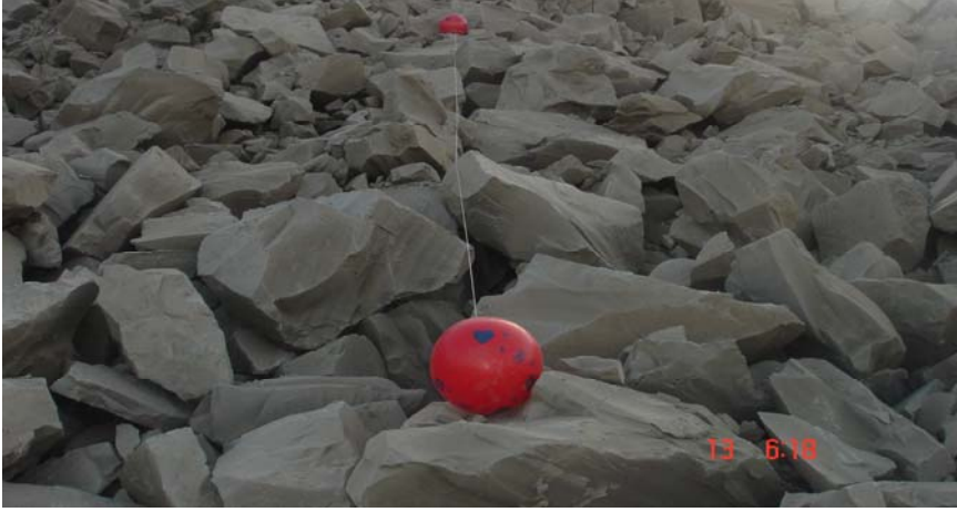
Şekil 4.29. Boyut dağılımı analizinin uygulandığı bir yığın görüntüsü, 6 m x 5 m delik düzeni (büyük ölçek)
