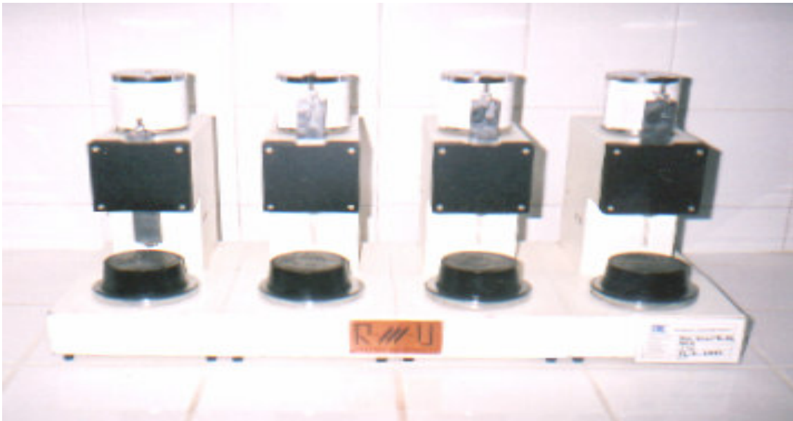
Şekil 5.3 Toni Technik 7320-100 marka priz başlama ve sona erme süreleri tayin cihazı.
