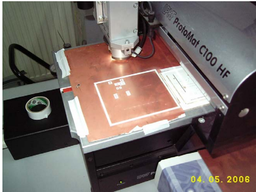
Şekil 4.5 LPKF ProtoMat C100 HF devre kazıma cihazı
