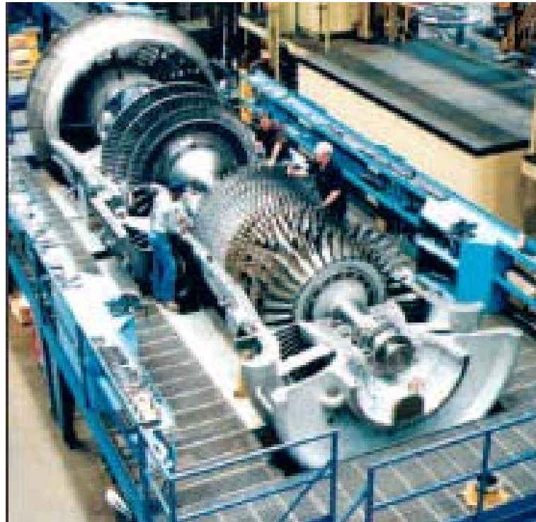
Şekil 2.7 Gaz Türbinli Kojenerasyon Sisteminde Kullanılan Türbinin Açık Hali.
