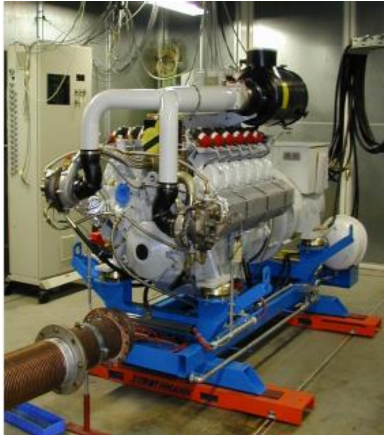
Őekil 2.8a. Gaz Motorlu Kojenerasyon Sisteminde Kullanılan Motor Tipi (500 kW) [17].
