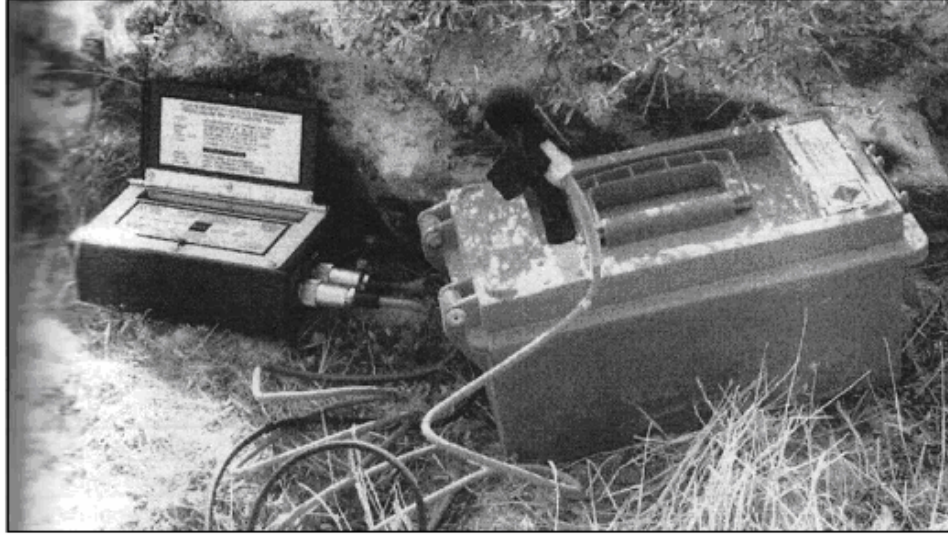
Şekil 3.2 Mini Seis II model ölçüm cihazının görünümü
