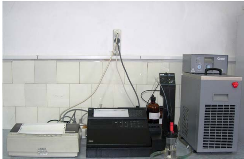
Şekil 3.6 Denge sabiti tayininde kullanılan potansiyometrik sistem
