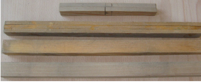
Protim 230WR ile Emprenye edilmiş Sarıçam, Karaçam ve kayın odunu
