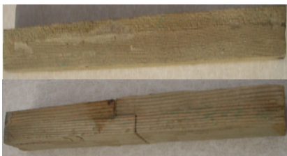
Tanalith-C ile Emprenye, Poliüretan Tutkalı ile lamine edilmiş Sarıçam odunu
