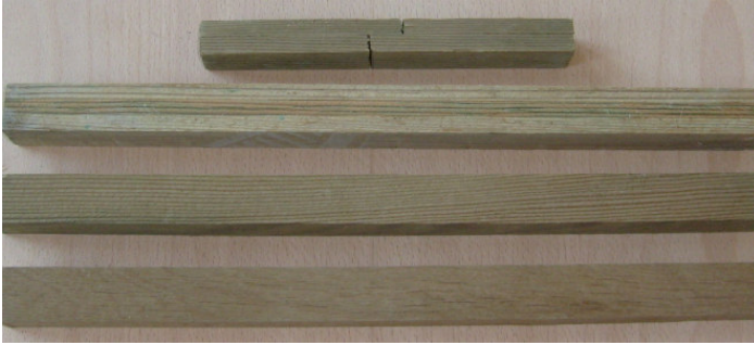
Tanalith-C ile Emprenye edilmiş Sarıçam, Karaçam ve kayın odunu
