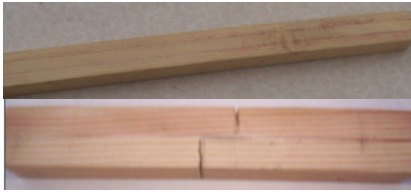
Protim 230WR ile Emprenye, Pva Tutkalı ile lamine edilmiş Sarıçam odunu
