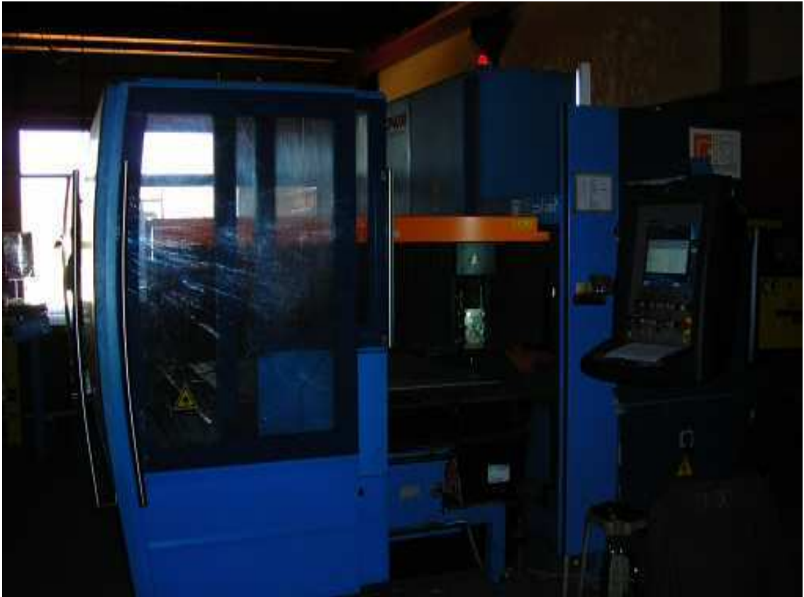
Şekil 4.2 Kesme işleminde kullanılan Lazer tezgahı.
