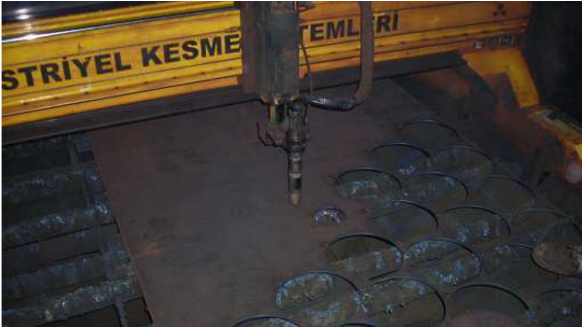
Şekil 4.3 Kesme işleminde kullanılan CNC Oksijen ve Plazma tezgahı.
