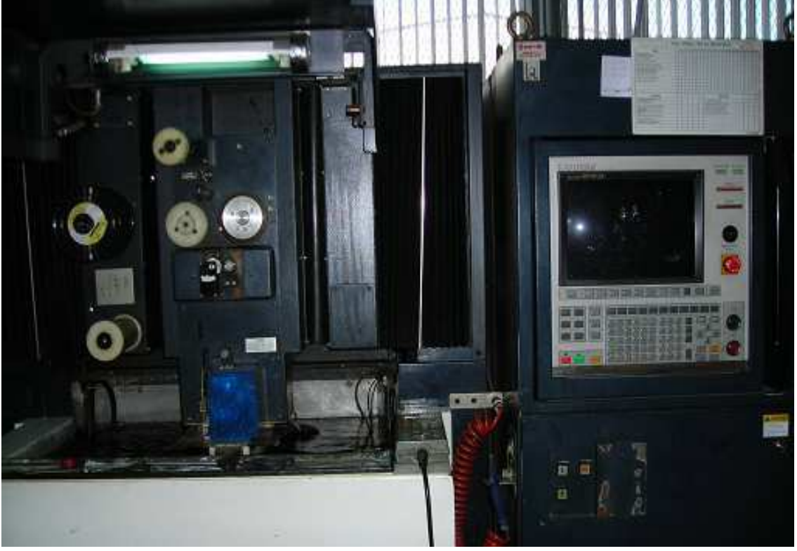
Şekil 4.4 Kesme işleminde kullanılan Tel Erozyon tezgahı.
