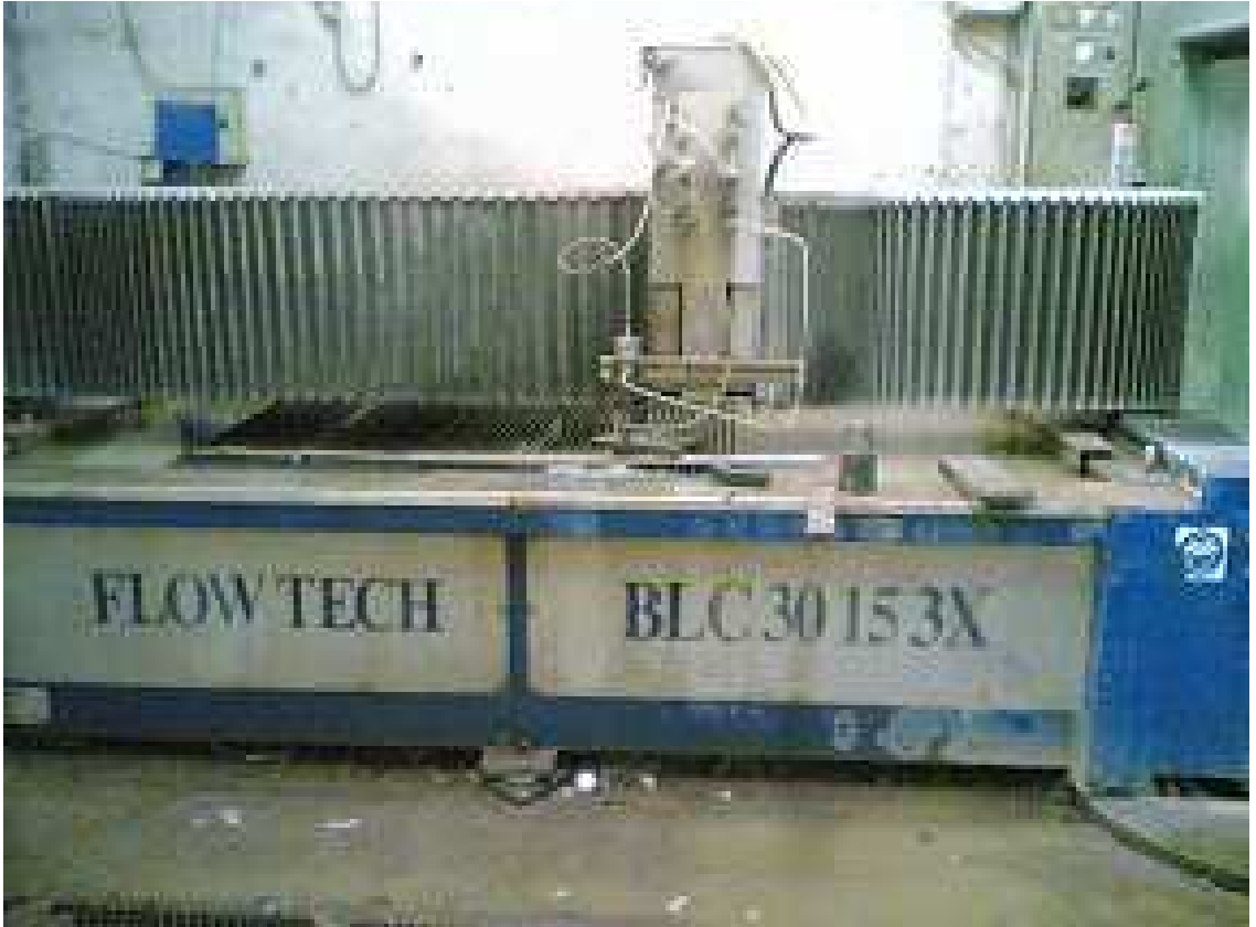
Şekil 4.1 Kesme işleminde kullanılan Su Jeti tezgahı.
