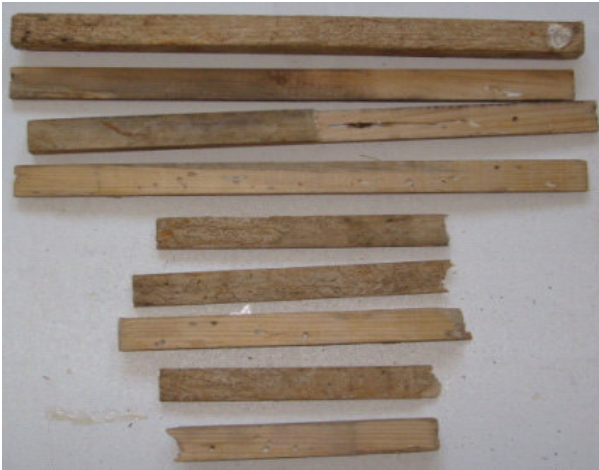
Kontrol karaçam örneklerinin 12 ay sonunda deniz içerisinde deniz delicileri tarafından çeşitli çaplarda meydana getirilen tahribatlar görülmektedir.
